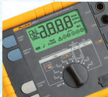
Fluke 1625-2를 사용하여 접지 시스템의 상태를 파악할 수 있습니다.
