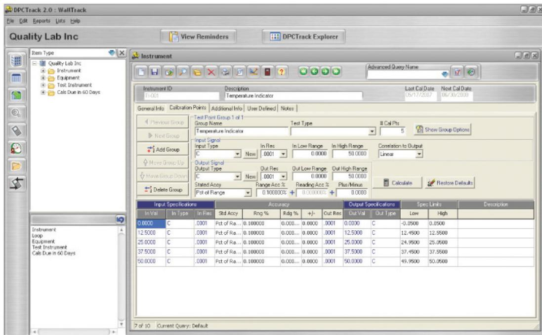
Fluke 750SW DPC/TRACK 2 소프트웨어는 기기를 관리하고, 테스트를 만들며 테스트 일정을 잡고, 753 또는 754를 로드/언로드하고, 다양한 표준 보고서를 인쇄하고, 교정 데이터를 관리하는 작업을 용이하게 하는 기기 데이터베이스를 포함하고 있습니다.
